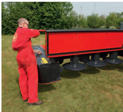
De complete voorkap kan omhoog geklapt worden voor goede toegang naar de trommels.
